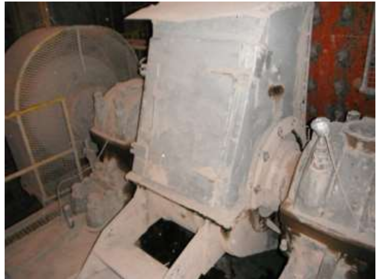
Figura 6: vista de accionamiento piñón y cojinetes respectivos.
