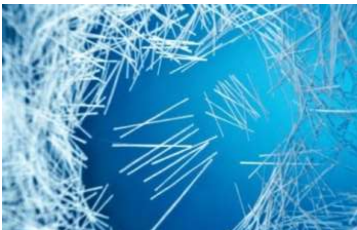
Figura 1. Existe una amplia variedad de fibras para uso en hormigón. Figura 1 a (arriba) Fibras de acero: dosis típicas en hormigón entre 20 y 80 kg/m 3 ; en las microfibras que se usan para compuestos de ultra alta resistencia en dosis entre 80 y 300 kg/m 3 . Figura 1 b (centro) macrofibras sintéticas, dosis típicas entre 2 y 8 kg/m 3 . Figura 1 c (abajo) macrofibras de vidrio (diámetro equivalente 0,30 a 0,60 mm, longitud 24 a 36 mm), dosis típicas entre 5 y 15 kg/m 3 .
